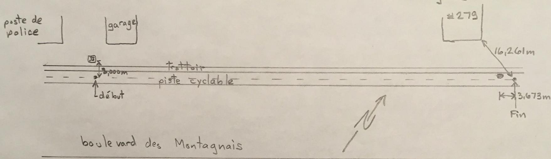
début: clou à béton planté sur ligne de centre de la piste cyclable à 3,000 m du boulon sud-est de la base de lampadaire
